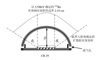
图A.1 半球形扩散型氡剂量计结构示意图
