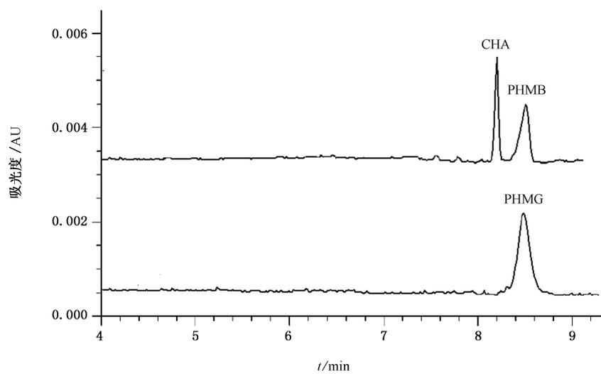
图 B.1 PHMB、PHMG、CHA 的毛细管电泳图
