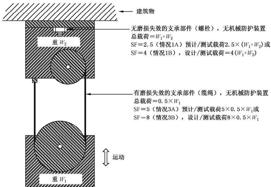
图 A.18 确定设计和测试载荷示例
