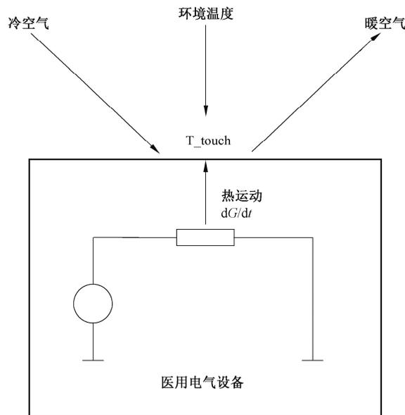
图 A.22 高海拔下设备表面和应用部分的最高容许温度
