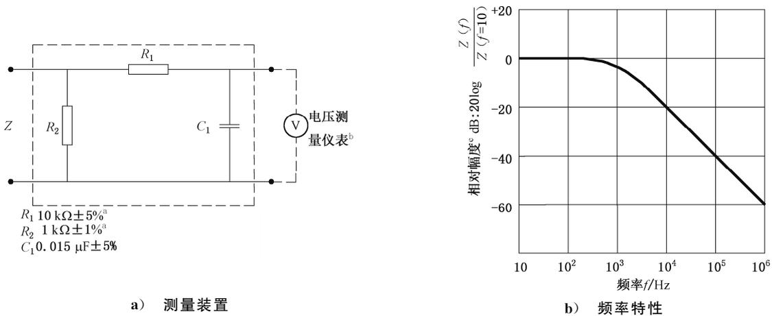
注: 在后面的图中用符号 **MD** 来代替上述的网络和电压测量仪表。
