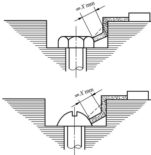
条件:螺钉头和凹座壁之间的间隙狭到不必考虑的程度。
