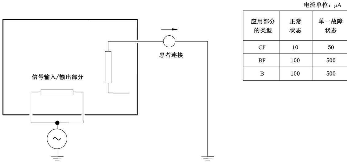
采用图 F.1 的测量供电电路的图例。
