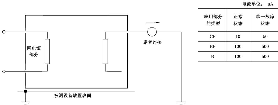
采用图 F.1 的测量供电电路的图例。
