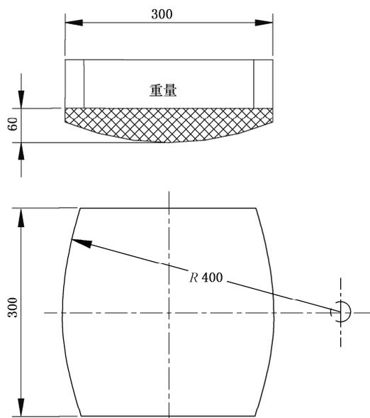
注:人体重量模型的顶槽是由木质、金属或类似材料制成。槽预期用于装载适当的人体重量,多采用高密度材料(例如,铅)。底座部分采用泡沫材料。由于随重物一同跌落,泡沫材料的属性似乎并不重要,所以未规定泡沫材料的弹性或弹力系数(ILD 或 IFD 等级)。泡沫材料是圆柱形而不是球形。
